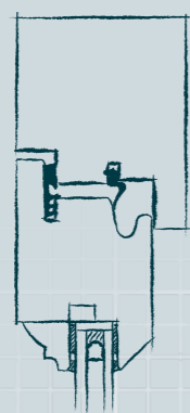
Traverse haute Possibilité d'intégrer une ventilation haute.
